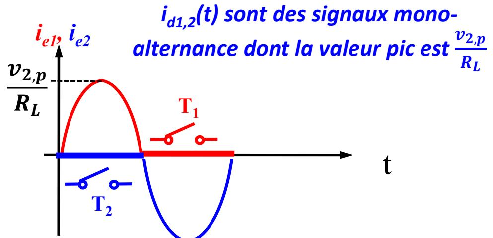
Les valeurs moyennes des courants  $\overline{i_{d1,2}}$  de  $T_1$  et  $T_2$
