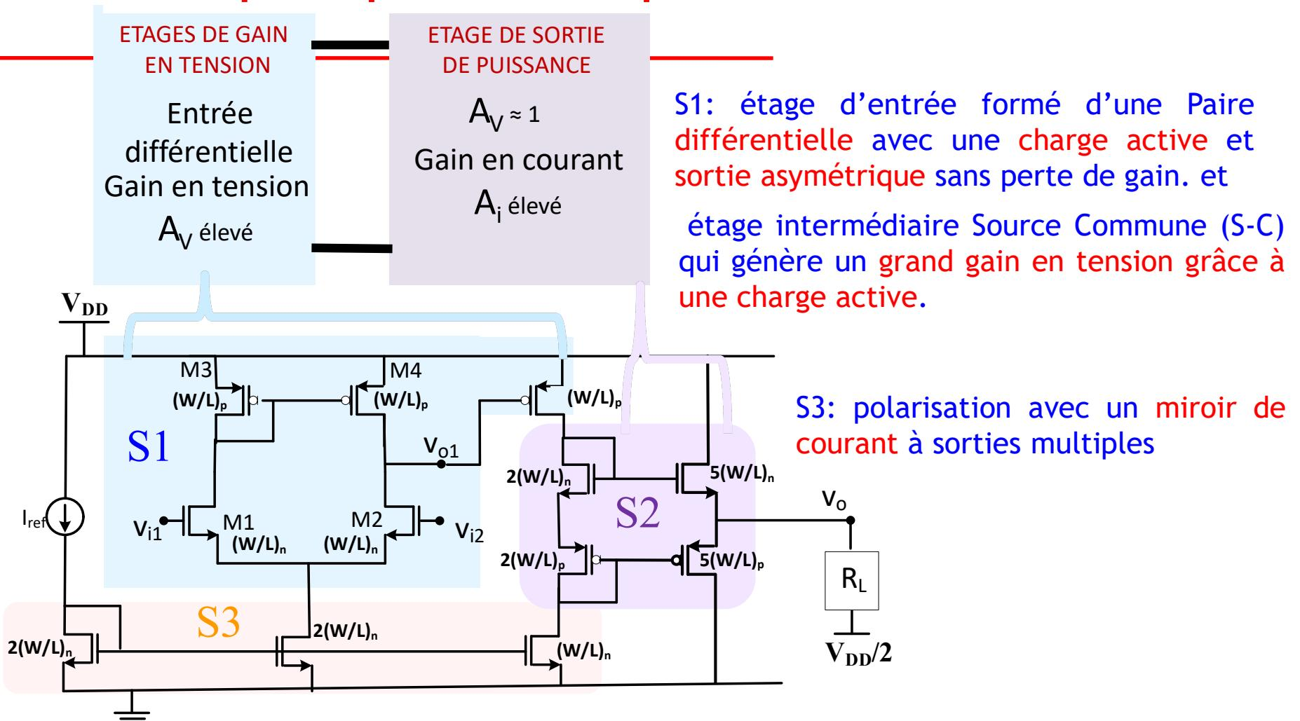
S2: étage de sortie push-pull à grande impédance d'entrée et faible impédance de sortie avec un gain en tension unitaire, mais un gain en courant  $\gg 1$  capable de fournir le courant nécessaire à la charge  $R_L$ .
